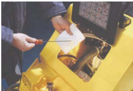
Foto 1: Noua carcasă asigură protecție totală și este prevăzută cu balamale și uși de vizitare, întreținerea dispozitivului fiind astfel posibilă fără îndepărtarea carcasei.
