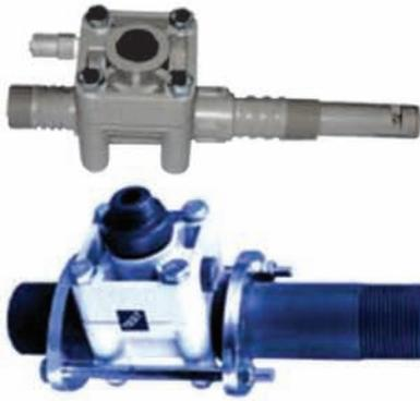
Ejectorul este un dispozitiv care generează vacuumul necesar pentru introducerea clorului gazos în apă. Principiul de funcționare se bazează pe crearea de vacuum cu ajutorul unui tub Venturi. În ejector clorul gazos se combină cu apa, formând acidul hipocloros (soluția de clor) care este introdus în apa brută.
