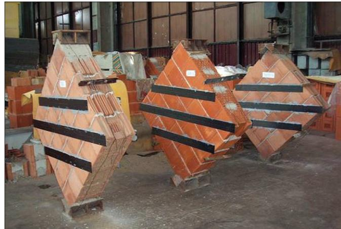
Fig. 6: Cele 3 specimene după aplicarea lamelelor din fibră de carbon
