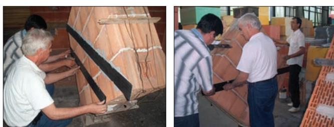
Fig. 5: Confectionarea specimenei, cu aplicarea lamelelor Carbodur S 1012
