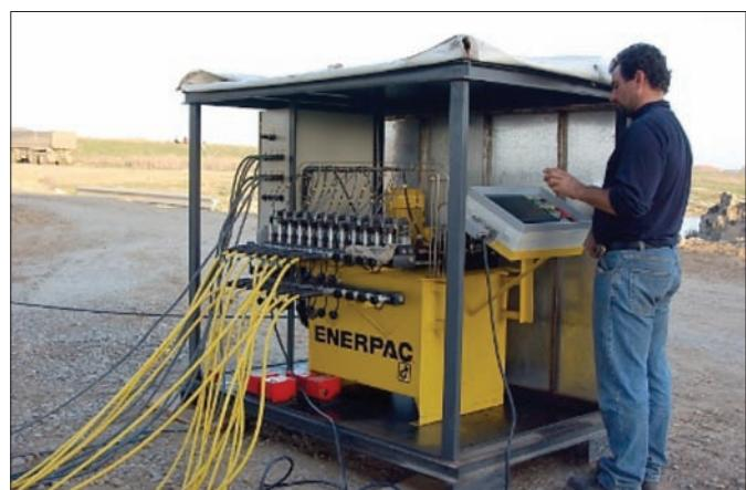
Foto 6: Sistem de ridicare sincronă controlată de calculator
