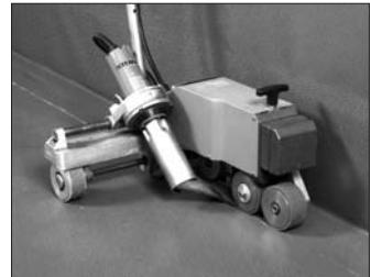
Fig. 5: Echipament de sudură automat (se elimină, în acest fel, sudura manuală)
