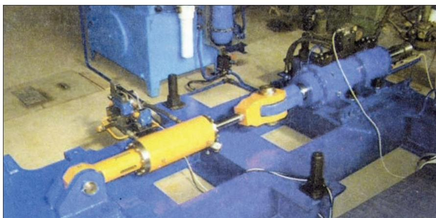
Stand pentru testarea disipatorilor hidraulici semiactive utilizati în construcții
