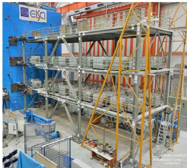
Structură duală cu capacitate de recentrare, încercată pseudo-dinamic în Laboratorul ELSA de la JRC Ispra (Italia), în cadrul proiectului european DUAREM, coordonat de UPT-CMMC
