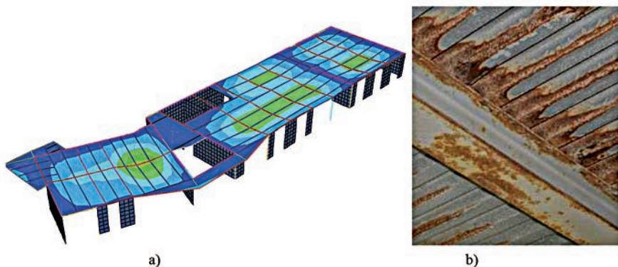
Fig. 7: Forma deformată din încărcări gravitaționale pe un nivel curent (a) și vedere cu coroziunea extinsă din tabla cutată de la planșeu și coroziunea locală din grinzi (b)
