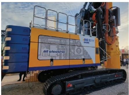
Utilajul, echipat cu baterii și cu motor electric de mare capacitate, funcționează fără emisii de CO<sub>2</sub>.
