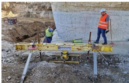
Test la compresiune asupra unui micropilot
