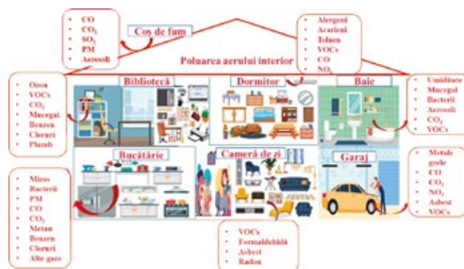
Fig. 1: Tipuri de poluanți ai aerului din spații cu diferite destinații și sursele acestora (prelucrare după Kumar et al., 2023)
