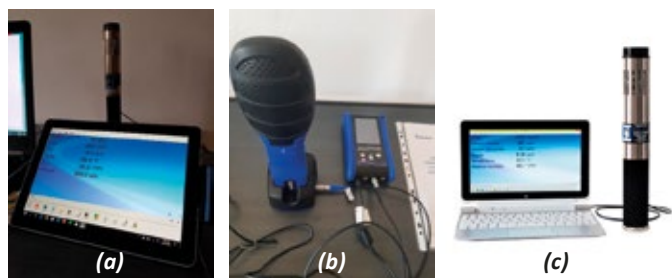
Fig. 3: (a) DirectSense IQ-610 și tableta GrayWolf; (b) DirectSense II-8 și AdvancedSense Pro;
