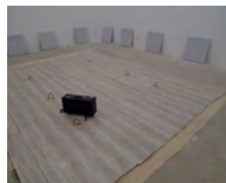
Fig. 5: Probă pe bază de lână montată în standul de izolare la zgomot de impact
