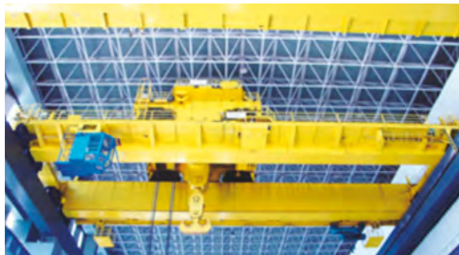
Sala mașinilor de la CHE PF I, cu structura reticulată a acoperișului, sistem care se aplica în premieră în România, și podul rulant de 400 t, cel mai mare din țară
