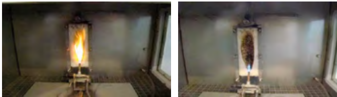
Fig. 2: Comportare a unui produs pe bază de lână de oaie în timpul testului de determinare a aprinzabilității
