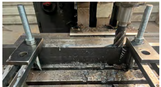
Fig. 8: Debitarea miezului la cote finite prin procedeu mecanic (frezare)
