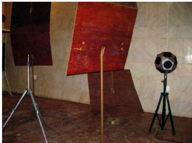
Foto 3: Imagine din camera de reverberație, cu echipamente amplasate în interiorul acesteia
