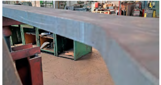
Fig. 7: Miezul BRB-ului după debitarea grosieră
