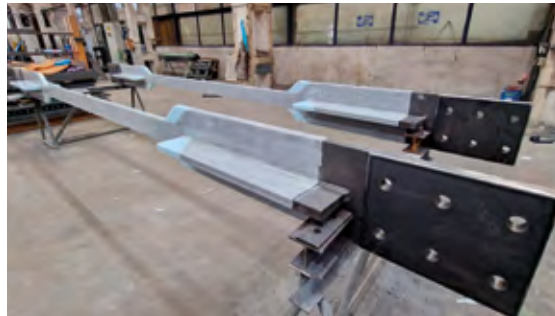
Fig. 11: Aplicarea stratului neaderent
