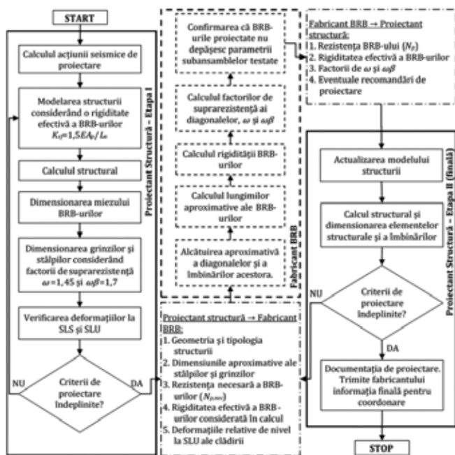
Fig. 3: Schema teoretică de proiectare a cadrelor contravântuite cu BRB-uri
