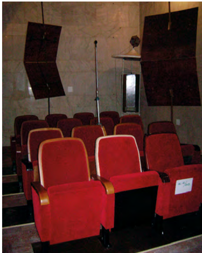
Foto 3: a) - imagine din camera de reverberație (cu probă realizată cu fotolii pentru sală de concerte)
