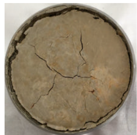
c) Compoziții cu pământ argilos și 0,25% fibre de lână
