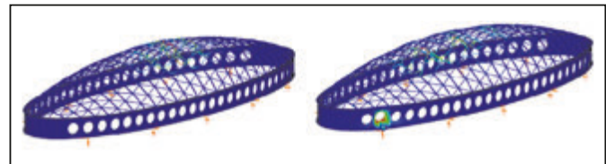
Fig. 11: Analiza stabilității (stânga: \alpha_{cr} = 10,74 ; dreapta: \alpha_{cr} = 14,17 )
