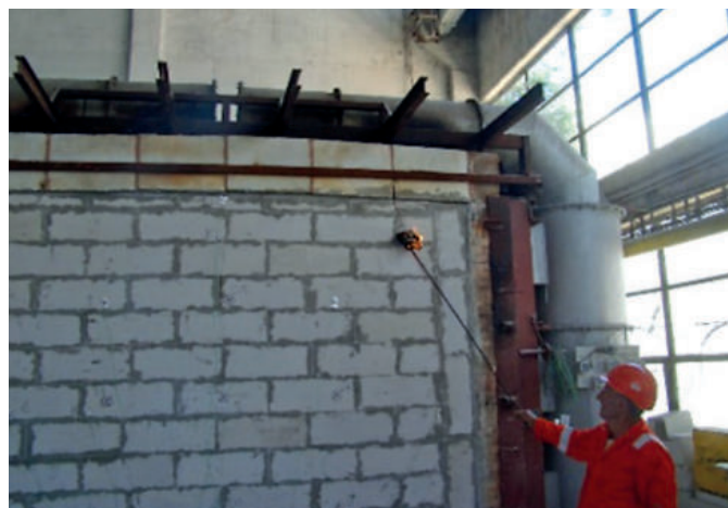
Fig. 5 a, b: Pierderea criteriului Etanșeitate la foc ( E ) prin aprinderea matorului din bumbac pentru epruvetele cu grosimea de 150 mm (a) și 200 mm (b)
