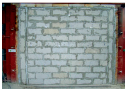
Fig. 1: Perete din zidărie de BCA pregătit pentru testare la rezistență la foc
