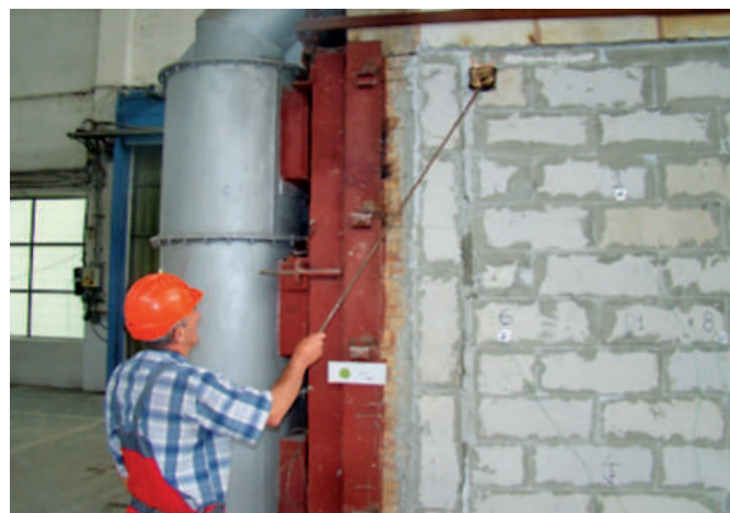
Fig. 5 a, b: Pierderea criteriului Etanșeitate la foc ( E ) prin aprinderea matorului din bumbac pentru epruvetele cu grosimea de 150 mm (a) și 200 mm (b)
